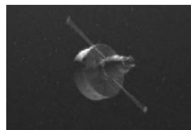
Figura 8.18: Sistema yo-yo de frenado del giro de la tercera etapa del Mars Exploration Rover
