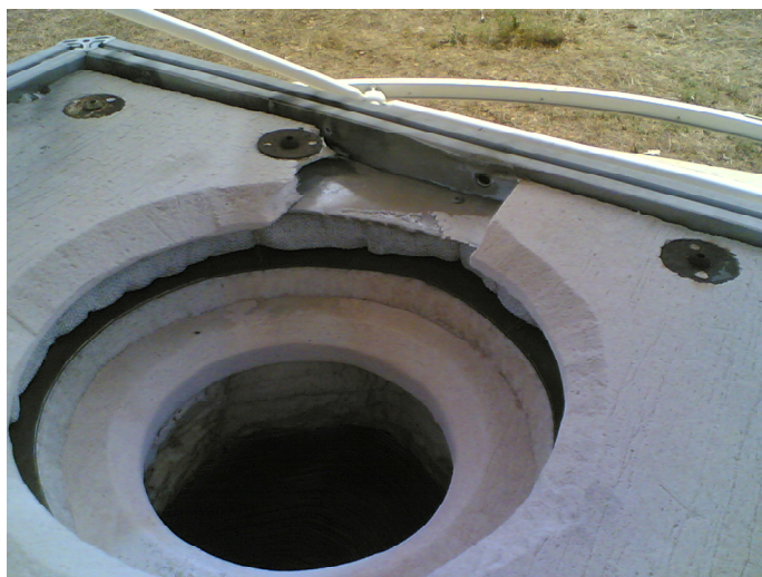
Figura 3-10. Fotografía de la primera rotura producida en la protección cerámica del motor.
