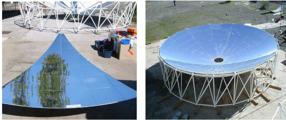
Figura 3-3. Fotografía de un segmento del concentrador (izquierda) y del concentrador completo (derecha)
