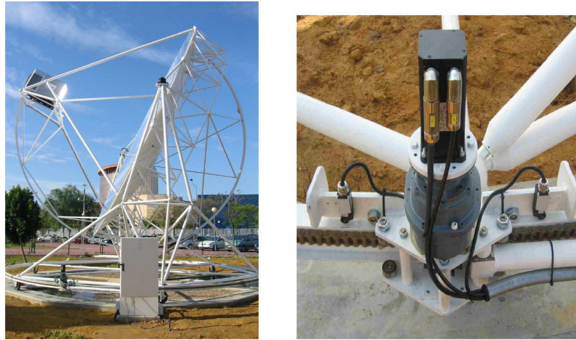
Figura 3-4. Fotografía de los arcos en movimiento (izquierda) y de un servomotor (derecha).
