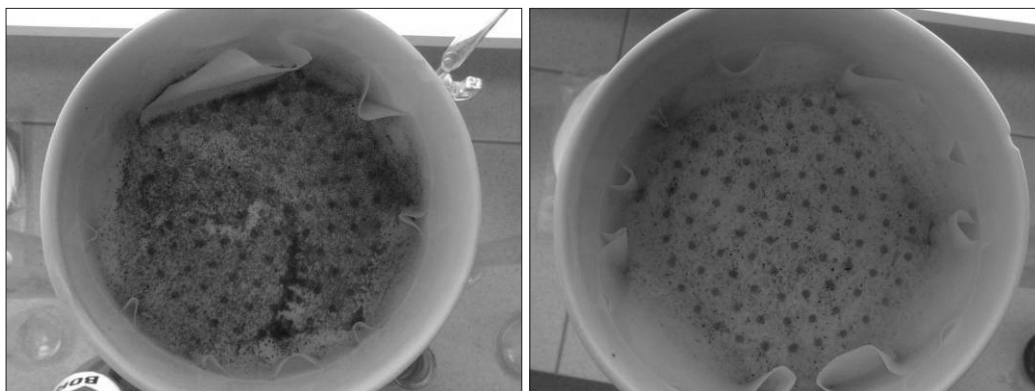
Рис. 2. Фильтры после фильтрования растворов: слева — раствор Chlorella sp. с флокулянтом «Сибфлок»; справа — чистый раствор Chlorella sp.
