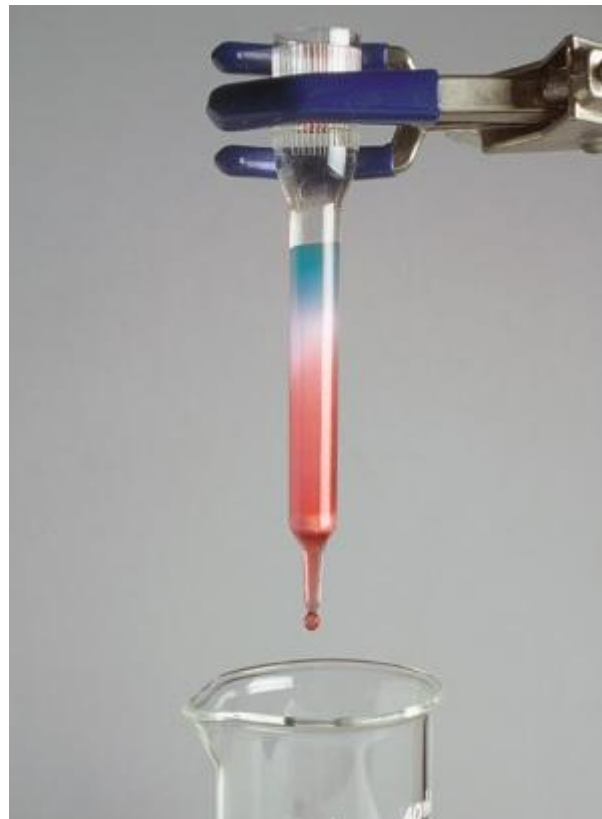
Figura 4: Separación de los colorantes en la columna.
