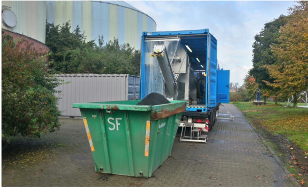
Abbildung 9: Schneckenpresse auf der Kläranlage Braunschweig (Foto: C. Görlich)
