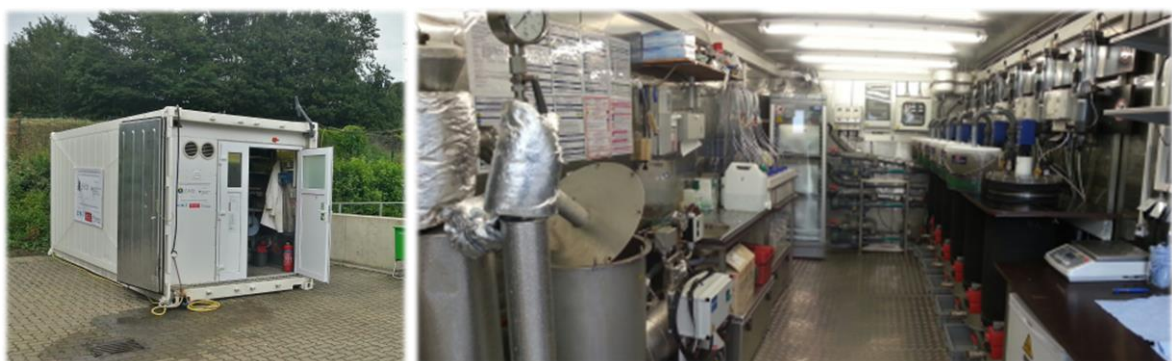
Abbildung 2: Mobile Untersuchungsanlage zur Schlammfäulung mit Thermodruckhydrolyse
