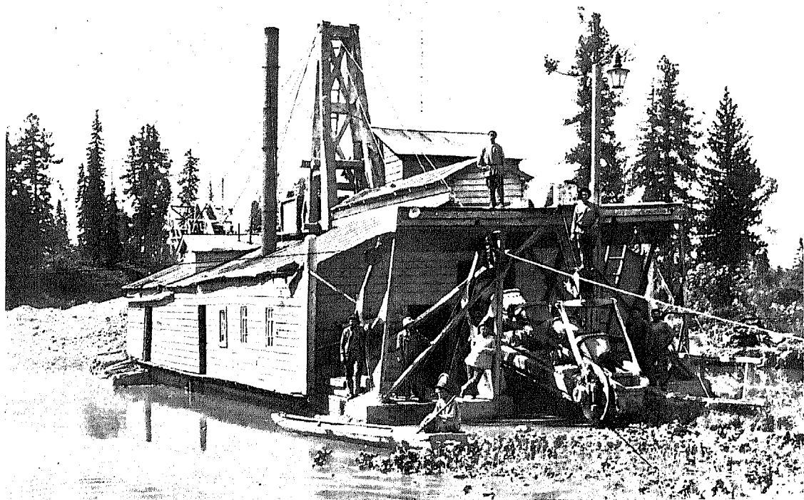
Драга, машина для разработки розсыпного золота.
