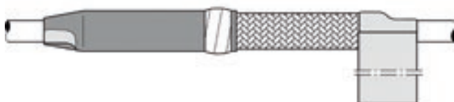
5) Kupfergewebeschauch auf die Verbindung schieben und mit Rollfedern auf den Schirmdrähten kontaktieren
