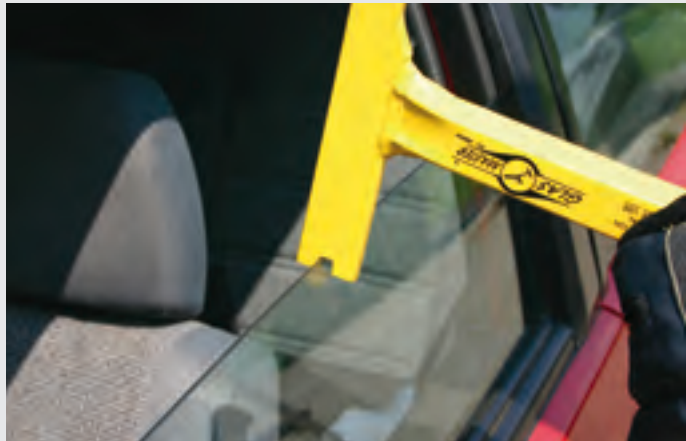
Einfaches und sicheres Brechen der Seitenscheiben mit dem Glasbrecher.
