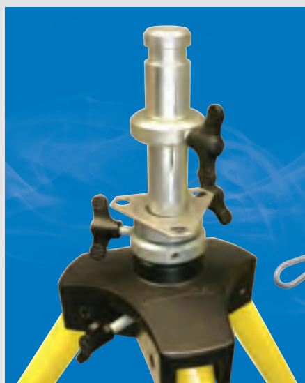
Damit die Rohre nicht verformt werden, benutzen wir ein spezielles, justierbares Klemmsystem.
