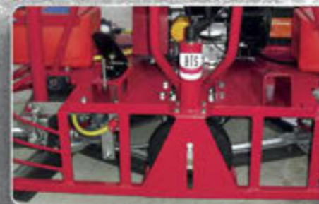
Integriertes Fahrwerk für einfaches Bewegen der Maschine und zu freiem Scheiben- und Flügelwechsel
