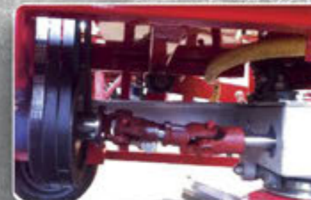
Dreifacher Riemenantrieb mit Kardangelen
