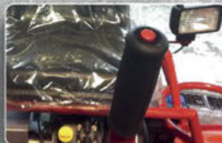
Bedienknopf für Wassersprühanlage
