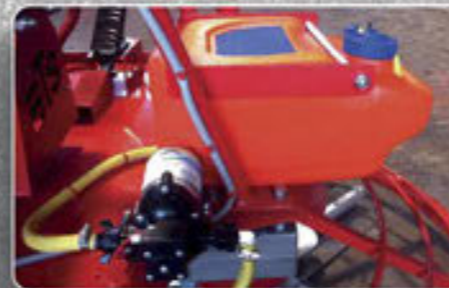
Wassertank mit Pumpe für Sprühanlage
