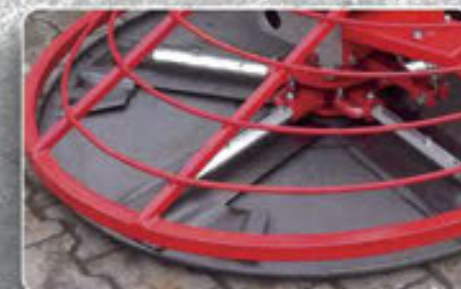
Pulverbeschichteter Rahmen verzinkte, lange Flügelarme
