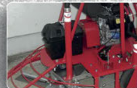
Geschützte Starterbatterie gegen äußerliche Schädigung
