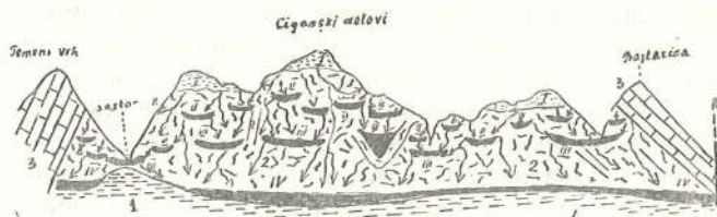
Проф. 1. Шемајски приказ издани и крећање подземне воде у црвеним пешчарима северно од Ниша. — I. Зона рудинске воде (поткорне издани); II. Сочивасте рауте издани; III- Обједињавајуће издани; IV. Хипотетична централна издан; 1. Карбонски глинци и песковите глине; 2 Црвени пешчари; 3. Баремски кречњаци.
