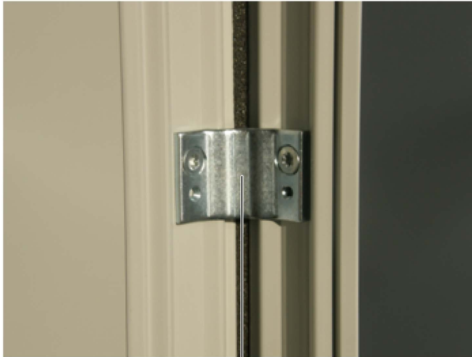
Elemento de unión exterior Par de apriete: 9 Nm
