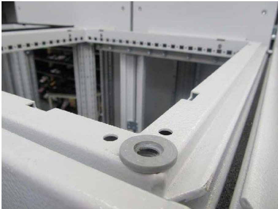
Figura 3-18 Colocación de la arandela
