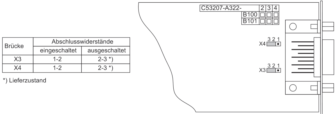
Bild 3-11 Lage der Steckbrücken für die Konfiguration der Abschlusswiderstände der Profibus- (FMS und DP), DNP 3.0- und Modbus-Schnittstelle
