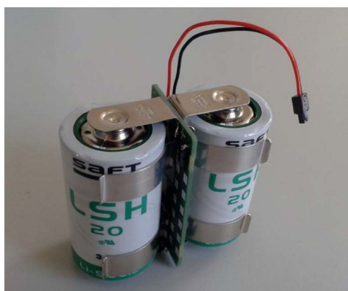
Figura C-4 Soporte con baterías insertadas
