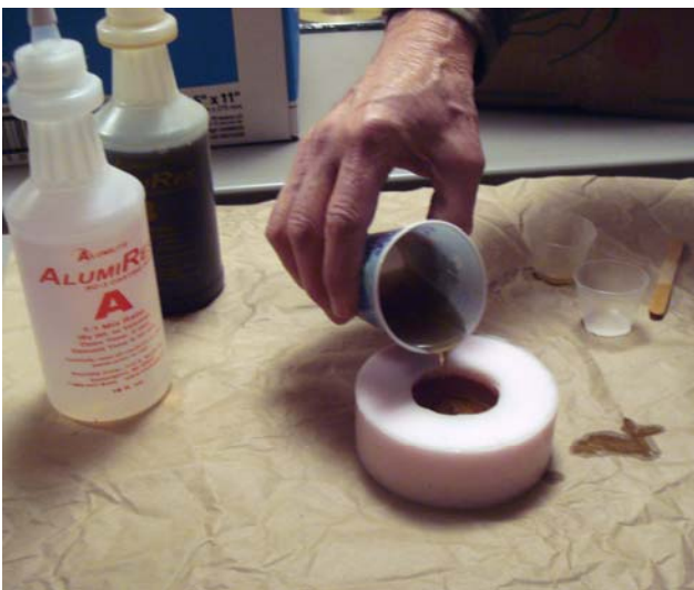
Fig. 7: Pour the resin into the mold.
