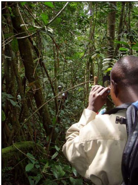
Figure 4 : Visées sur lignes avec une boussole
