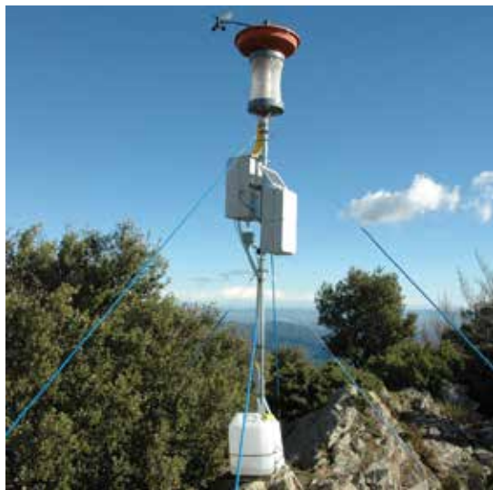
Estació meteorològica equipada amb captació d'aigua procedent de la boira. (Fotografia: D. Guinart)
