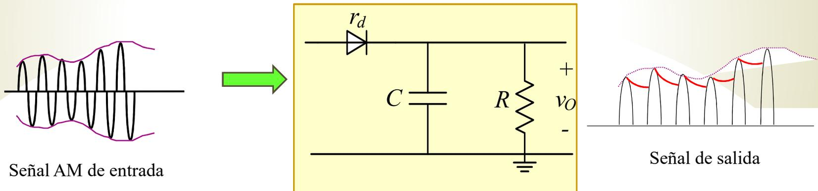
El circuito detector de envolvente, es un circuito detector de picos, o sea un rectificador acoplado a la red  $RC$  y su operación es sencilla
