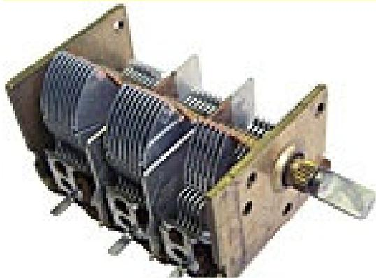
Condensador variable de tres secciones
