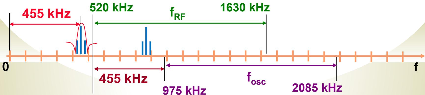
Aunque la portadora y las frecuencias de bandas laterales superiores e inferiores cambian de frecuencia (se trasladan a FI), el proceso de heterodinaje no cambia el ancho de banda de la señal
