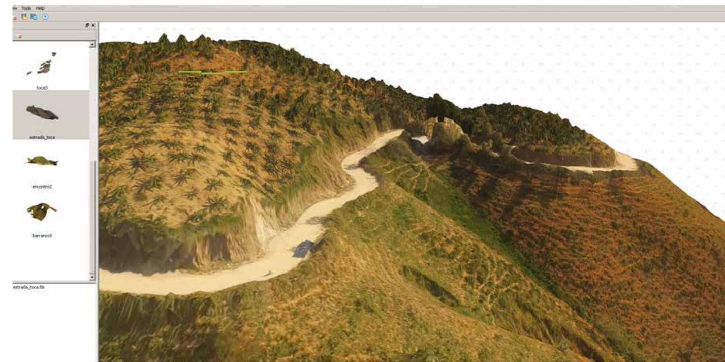
Exemplo de modelo tridimensional elaborado a partir de levantamento de drone, com pós processamento em software de fotogrametria.
