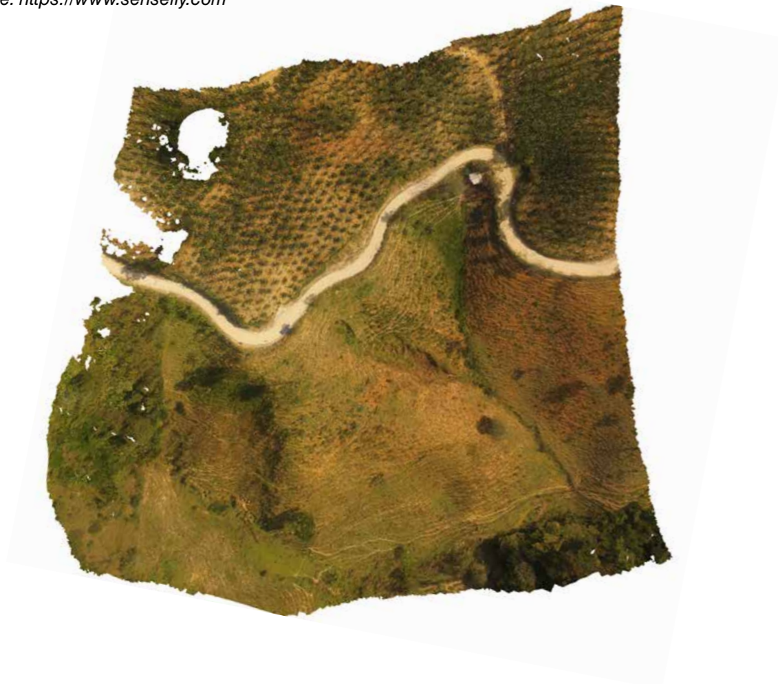
Exemplo da elaboração de ortofotos e modelos de superfície com grande detalhe.
