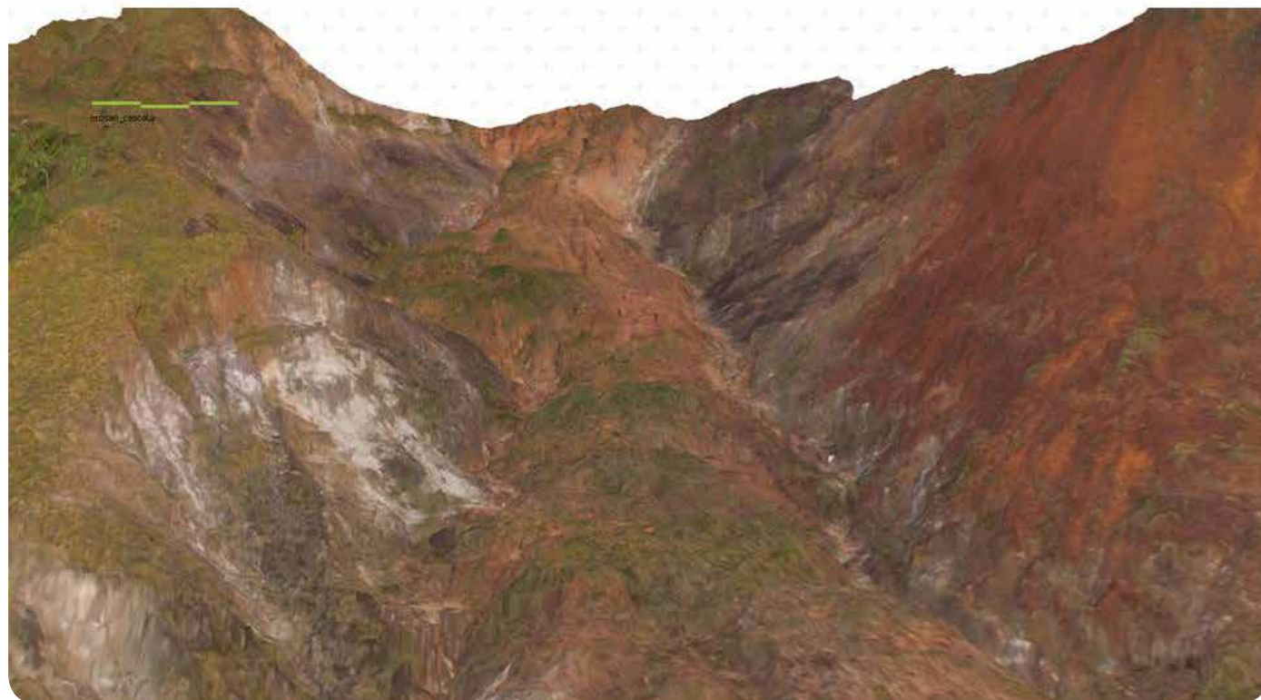
Modelo tridimensional obtido com VANT, da voçoroca localizada às margens da RJ 142
