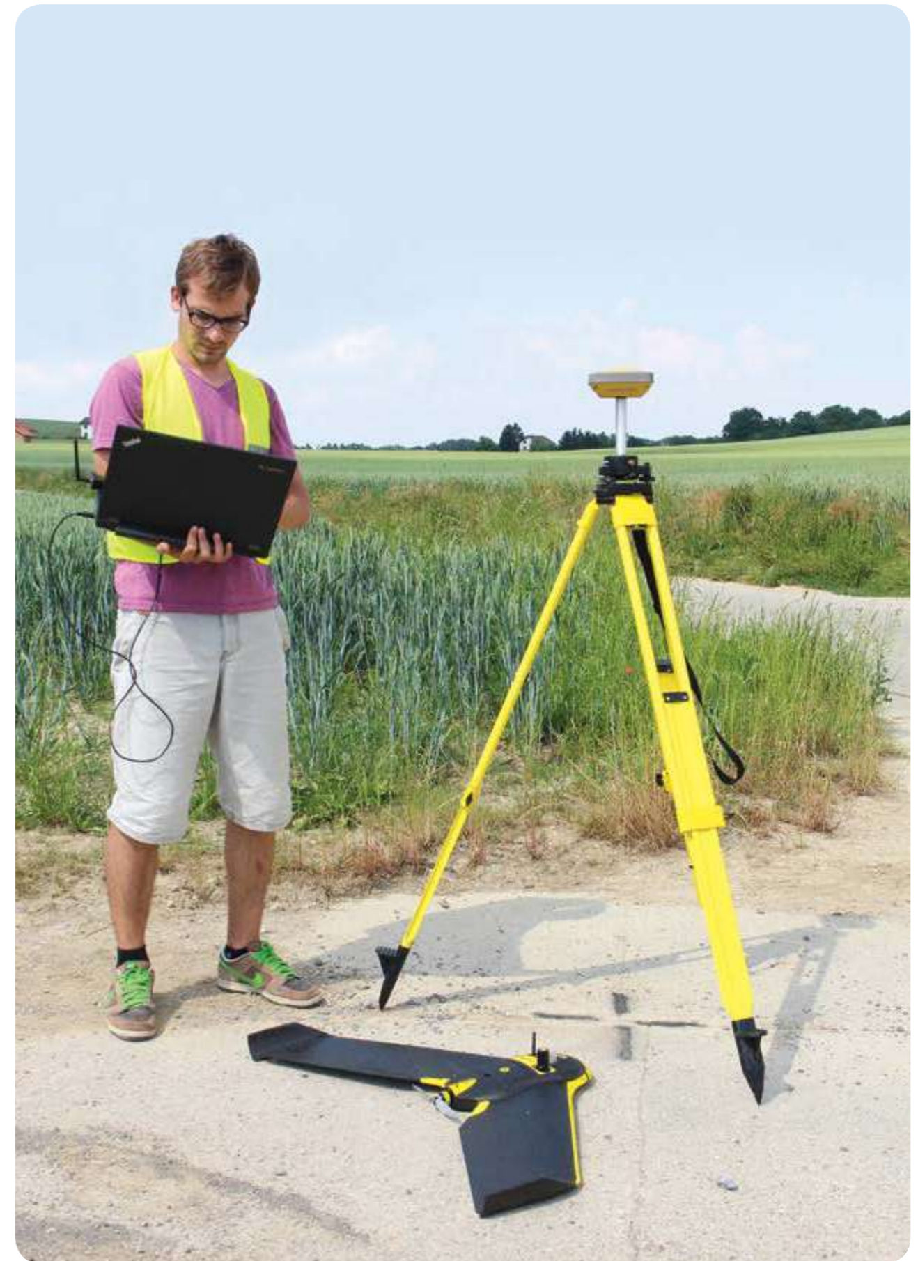
Exemplo da utilização dos VANTs, já com GPS geodésico RTK incluso.
