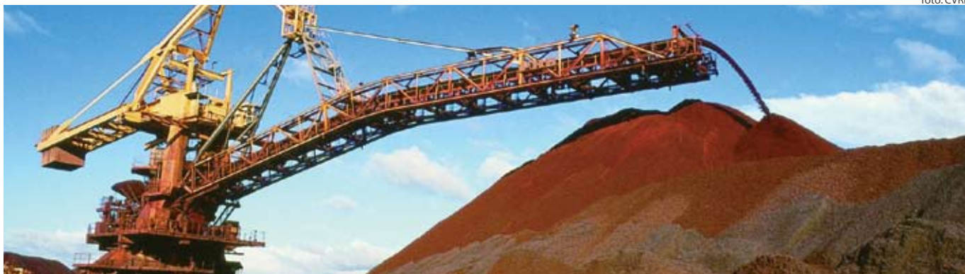
Empilhadeira de minério em Carajás: maquinário moderno para a logística de carga 鉄鉱石を採取：最新技術を駆使して輸送する
