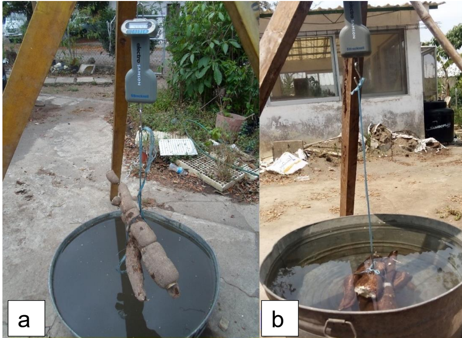
Figura 20. Toma de datos en raíces de yuca: a) peso fresco de las raíces al aire ( W_a ) y b) peso fresco de las raíces en agua ( W_w ).
