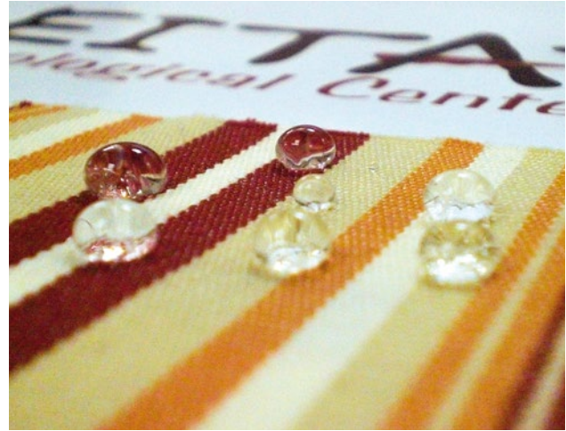
Figura 9. Repel·lència a l'aigua en teixit tractat amb plasma
