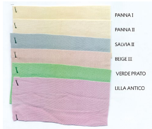
Figura 10. Tintura de teixit de polipropilè aplicant la tecnologia de plasma
