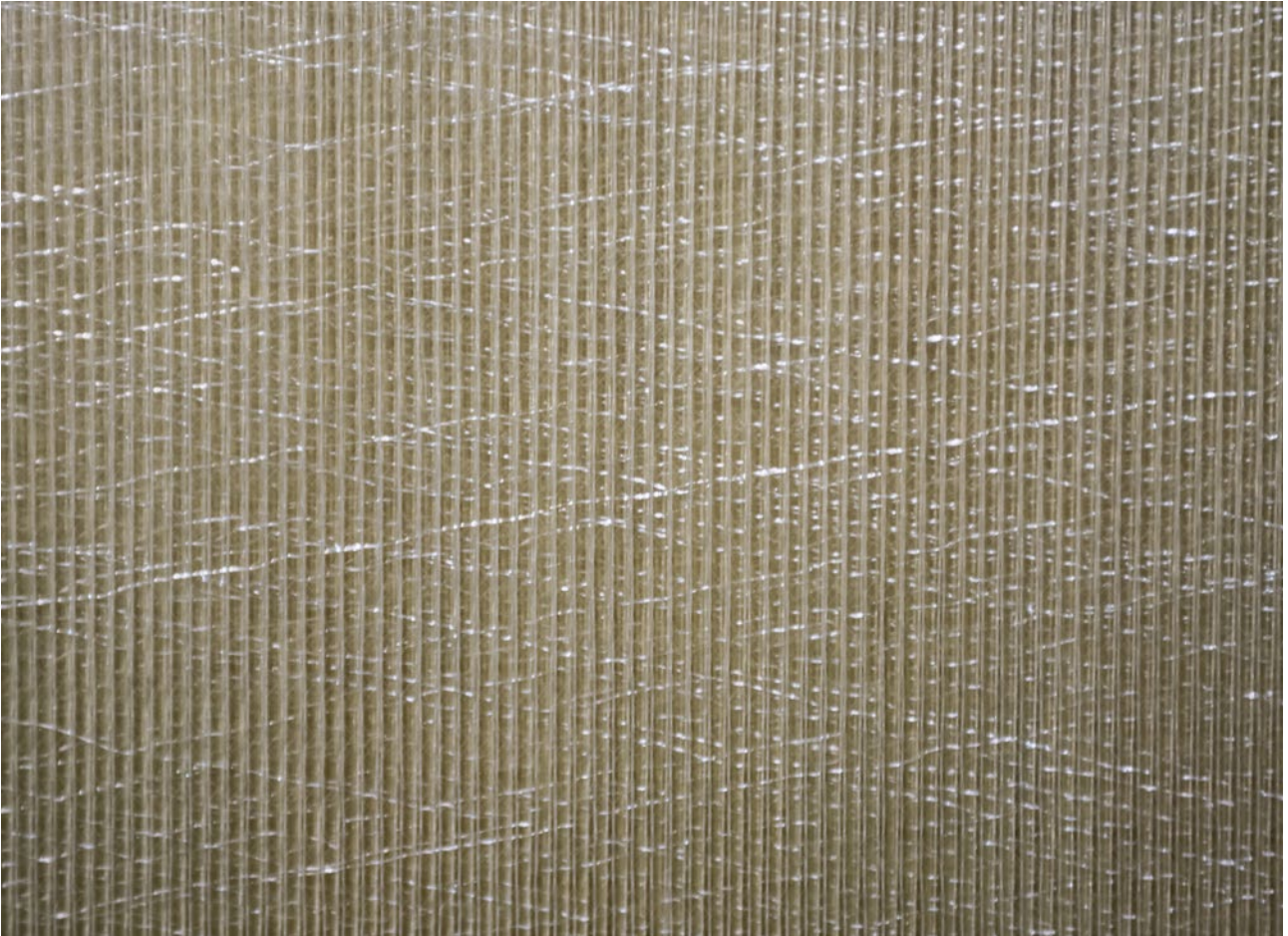
Composite que integra un teixit de fibra de vidre, destinat a la construcció d'aerogeneradors. Owens Corning, 2013.
