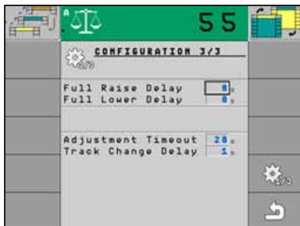
Figura 51. Pantalla 3 de CONFIGURATION (se muestran los parámetros predeterminados)
