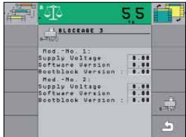
Figura 45. Pantalla 3 de BLOCKAGE (Bloqueo)
