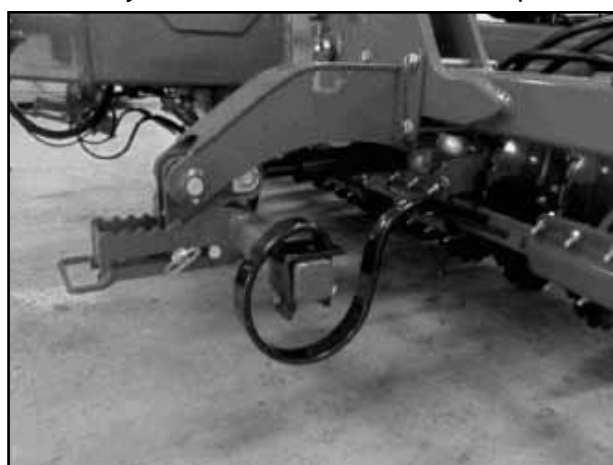
Figura 12. Desarraigadores en posición elevada.
