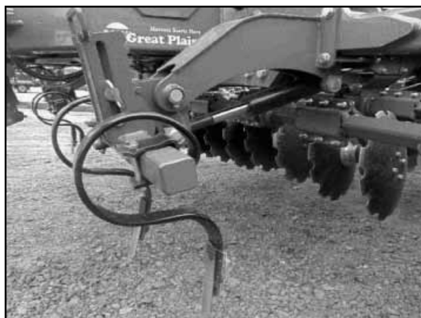
Figura 13. Desarraigadores en posición de trabajo.
