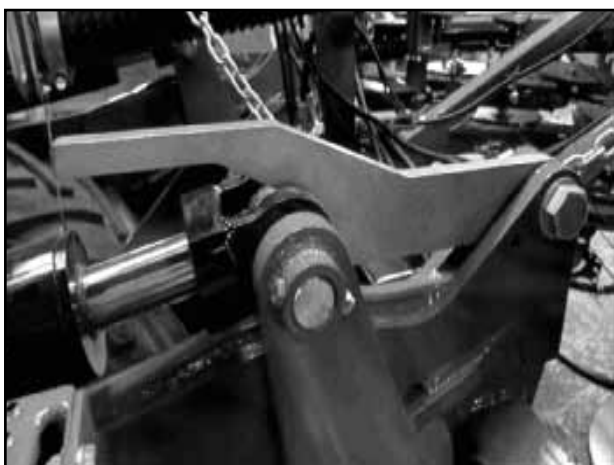
Figura 6. Canal de bloqueo en posición de mantenimiento
