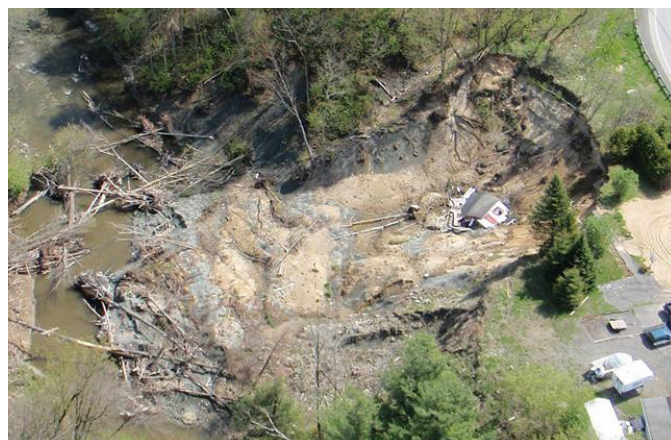
Figure 9 | Exemple de glissement rotationnel
