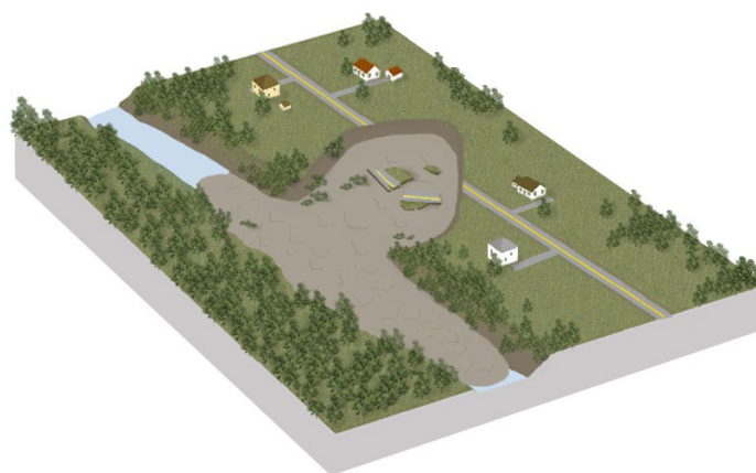
Figure 10 | Glissement fortement rétrogressif
