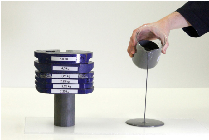
Figure 11 | Argile sensible au remaniement : à gauche, à l'état intact, et à droite, à l'état complètement remanié
