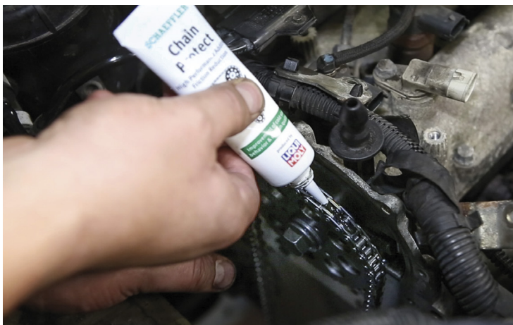
2. ábra: A Schaeffler Chain Protect-et a lánccsal történő szerelés során a vezérlésben minden komponensre felhordják.
