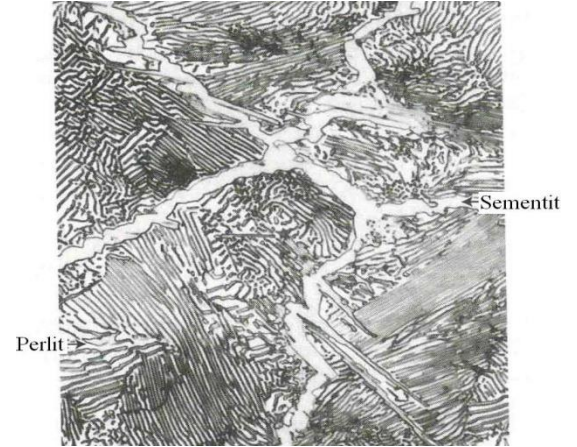
Yumuşatma tavına tabi tutulan ötektoid üstü çeliğin iç yapısı
