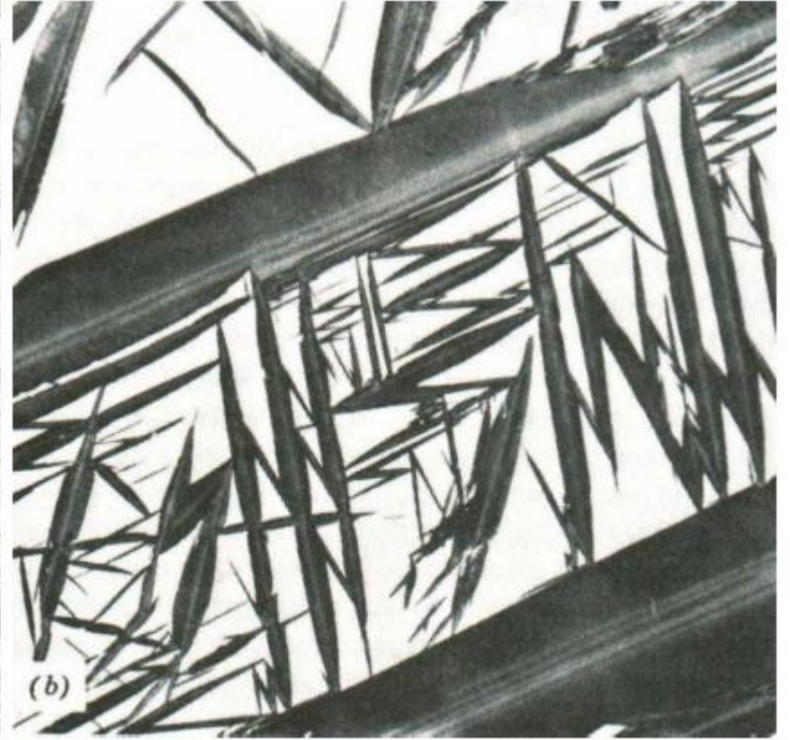
Şekil: a) Fe-0.09 C çeliğinde dilimli (x500), b) Fe-22.5 Ni-0.4 C alaşımında levha martensit
