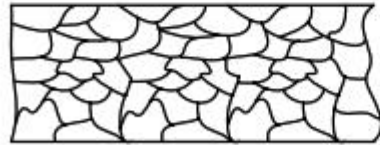
Soğuk şekil vermeden önce içyapı
