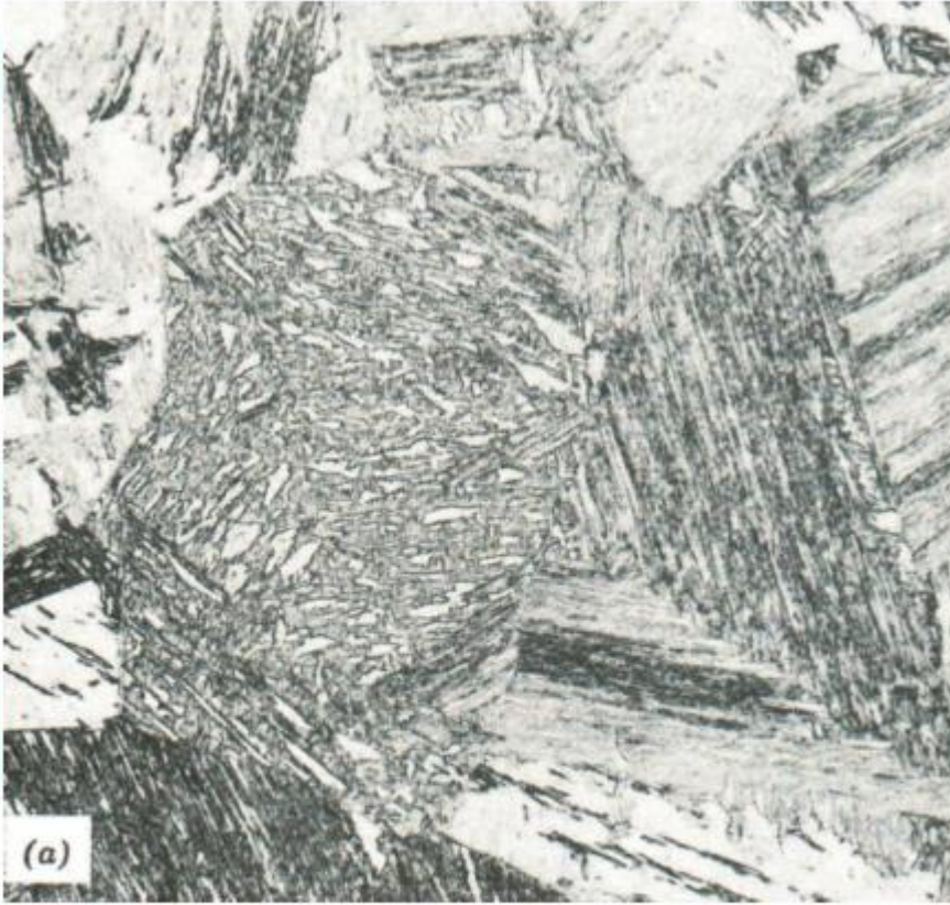
Şekil: a) Fe-0.09 C çeliğinde dilimli (x500), b) Fe-22.5 Ni-0.4 C alaşımında levha martensit
