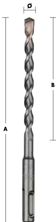
Hochwertige 2-Schneiden-Hammerbohrer mit 130°. Die HM-Schneidplatte ist für präziseres Bohren und längere Standzeit tief in den Bohrkopf eingelassen. Das 2-Spiral-Design sorgt für schnellen Bohrfortschritt, optimalen Bohrmehltransport und gute Standzeit.
