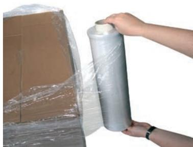
Mit vorgedehntem Hand-Film wird rollenweise gespart und sicher verpackt. Die vorgereckte Folie ist über 100 % in Längsrichtung vorgedehnt, wobei die gesamte Spannung in Querrichtung erhalten bleibt. So ist die Folie optimal vorgedehnt, gibt weder nach noch hängt sie durch. Die Folie umschließt auch schweres und unregelmäßiges Packgut schnell und sicher mit höchsten Haltekräften.
