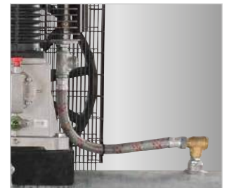
· Flexible Panzerschlauchleitung mit Hitzeschutz verhindert Vibrationsbruch
