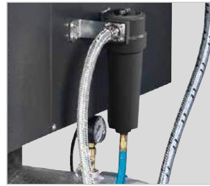
· Feinfilter als Filter vor der Druckluftentnahme zum Abscheiden von Kondensat und festen Verunreinigungen mit Partikeln bis 1 µm · Druckluftqualität nach ISO 8573-1
