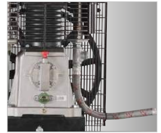
· Flexible Panzerschlauchleitung mit Hitzeschutz verhindert Vibrationsbruch
