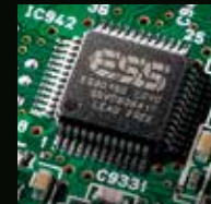
Ultra High Performance ESS ES9016 D/A Wandler für alle Kanäle
