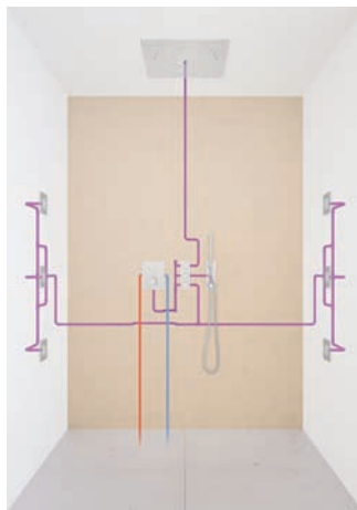
Zentralthermostat in der Brause mit 3-fach UP-Ventilen Grohtherm F
