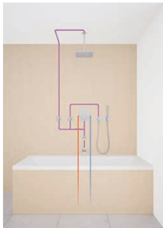
Zentralthermostat in der Wanne mit mehreren UP-Ventilen Grohtherm F
