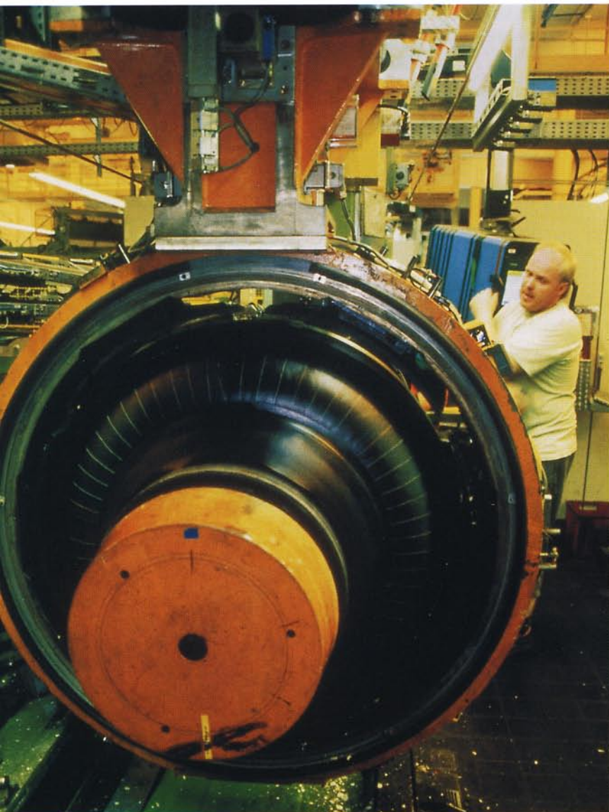
Unter Druck und durch Veränderung der Position wird die Karkasse von Nutzfahrzeug-Reifen automatisch mit dem Laufstreifengürtelpaket verbunden.
