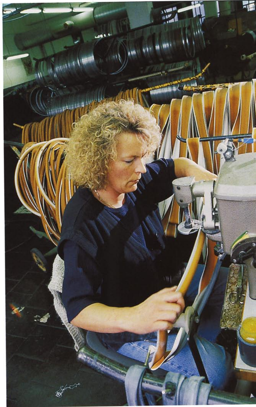
Beim Einnähen der Schläuche in hochwertige Fahrradreifen für den Rennsport ist präzise Handarbeit unerlässlich; Goldmedaillen können davon abhängen.
