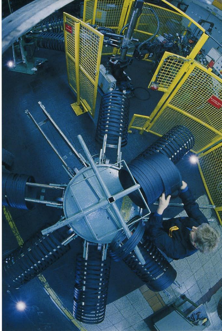
Ein Automat fertigt für Pkw-Reifen Drahtkerne, die den festen Sitz auf der Felge garantieren.
