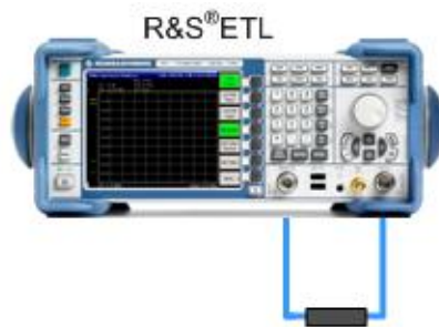
Abb. 19: Verkabelung um Kabel zu normalisieren
