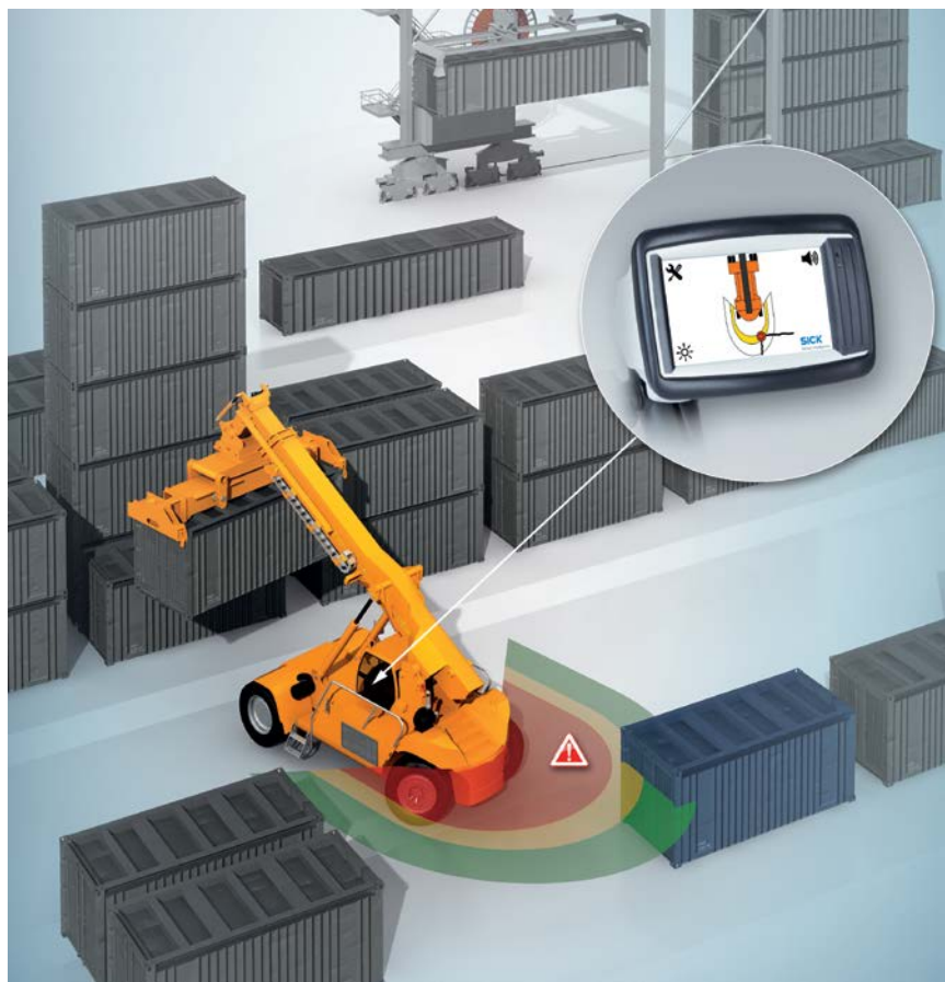
RAS Prime hjælper føreren: Overbejvise med tre advarselszoner og et betjeningsdisplay, som viser objekter, der kan være årsag til en kollision
