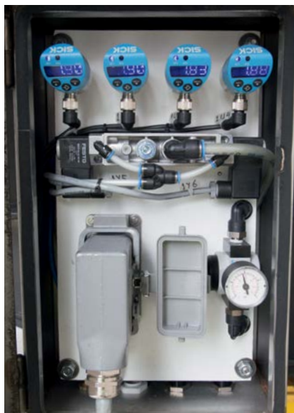
Fire PBS-tryksensorer overvåger tryk og undertryk
