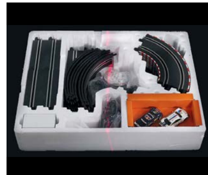
Positionskontrol af dele med specificeret position
