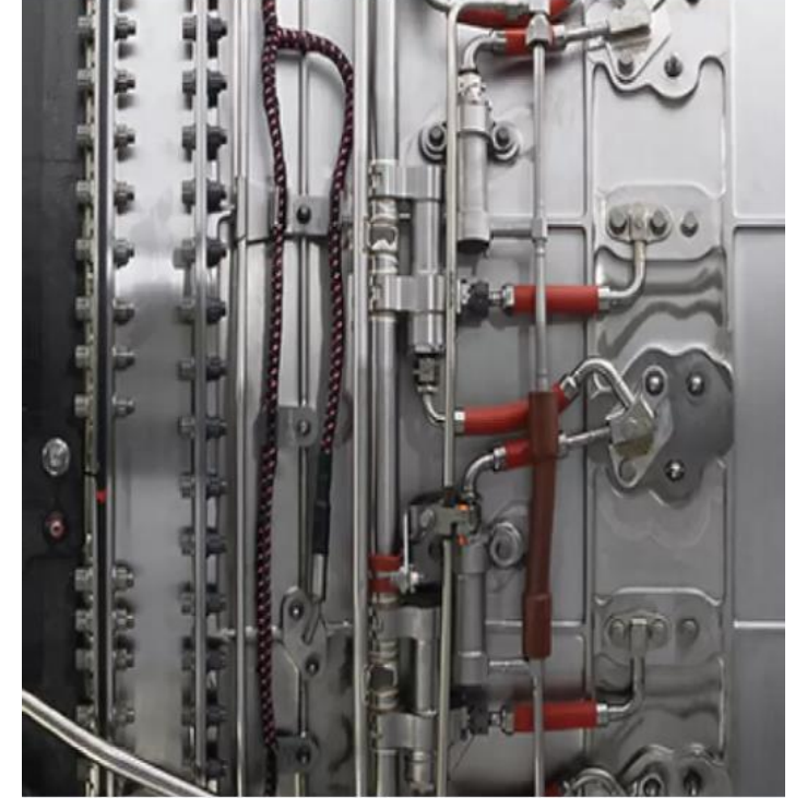
F414 Yakıt Enjektörü – Casing Arayüzü
