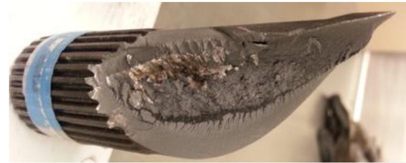
Sünek Malzeme -Dinamik Yükleme - Torsion Failure
