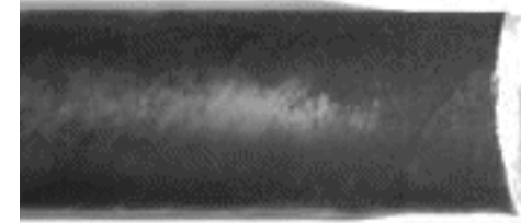
Sünek Malzeme- Statik Yükleme - Torsion Failure
