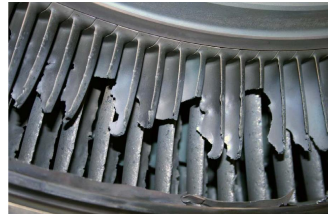
Sürünme (creep) sonrası LPT bladeleri
