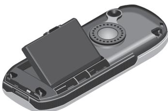
5. Akkudeckel leicht schräg halten und zuerst mit den unteren zwei Nasen ins Gehäuse einführen. Danach Deckel zuklappen, bis er einrastet.
