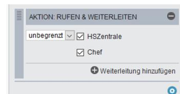
Wird die Checkbox in einer Rufaktion deaktiviert und es ist noch ein weiteres aktives Gerät vorhanden, wird die Ruf-Aktion nach dem eingestellten Intervall ausgeführt. Ist in einer Ruf-Aktion kein aktives Gerät vorhanden, wird sie nicht ausgeführt und einfach übersprungen.
