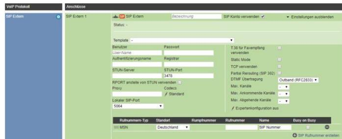
Nach der Auswahl des Templates/Provider werden in die auszufüllenden Felder die Begrifflichkeiten der Providerdaten hinterlegt. Dieses gilt für den SIP- als auch für den SIP-Trunk. Zusätzlich können Sie die automatische Aktualisierung des Template aktivieren.
