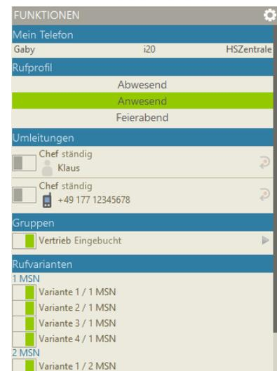
Die einzelnen Unterpunkte der Funktionsansicht können ein- bzw. auch ausgeblendet werden. Dazu ist zunächst mittels Zahnradsymbol der Editier-Modus zu starten, um dann anschließend die entsprechende Funktions-Checkbox ein- oder ausschalten.
