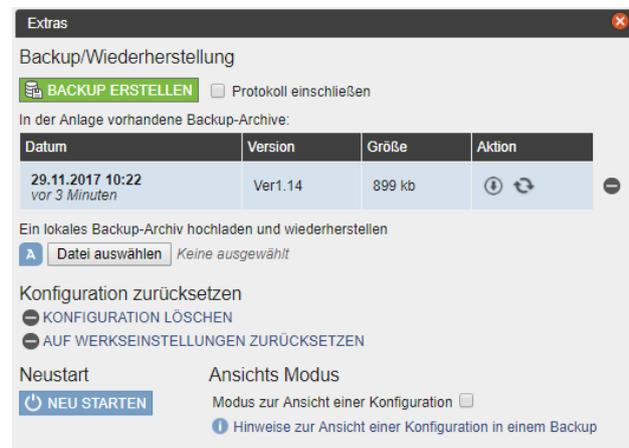
Ab der Firmware 2.2 besteht die Möglichkeit die Datensicherung mit einem Passwort zu verschlüsseln. Dieses Passwort wird bei der Rücksicherung wieder abgefragt. Sollte das Passwort nicht mehr bekannt sein, ist eine Rücksicherung mit dieser Datensicherung nicht möglich.
