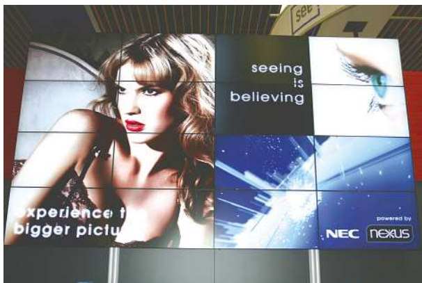
NEC MultiSync® X461UN Monitorwand mit einer Nexus-Lösung, welche partiell in 2x4 und zwei Bereiche in 2x2 Displays aufgeteilt sind. Die Steuerung erfolgt unabhängig voneinander.
