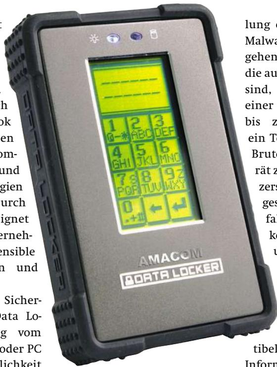
lung etwa durch Trojaner oder Malware auf dem Rechner zu umgehen. Der Zugriff auf die Daten, die auf der Festplatte gespeichert sind, erfolgt nach der Eingabe einer individuell festgelegten bis zu 18stelligen PIN über ein Touchscreen-Display. Gegen Brute-Force-Angriffe ist das Gerät zusätzlich mit einem Selbstzerstörungsmechanismus ausgestattet, der bei wiederholter falscher PIN-Eingabe eine komplette Reinitialisierung und Formatierung der Festplatte mit Löschung aller Daten notwendig macht.
