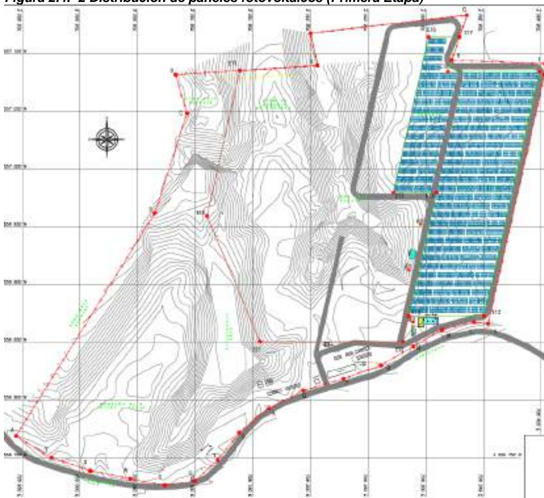
Figura 2.4.- 2 Distribución de paneles fotovoltaicos (Primera Etapa)
