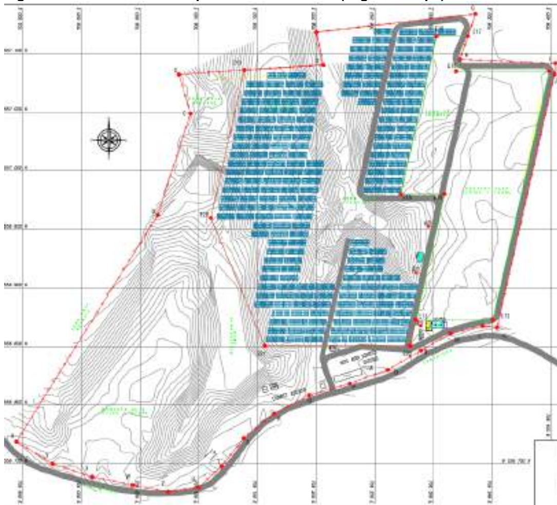
Figura 2.4.- 3 Distribución de paneles fotovoltaicos (segunda etapa)
