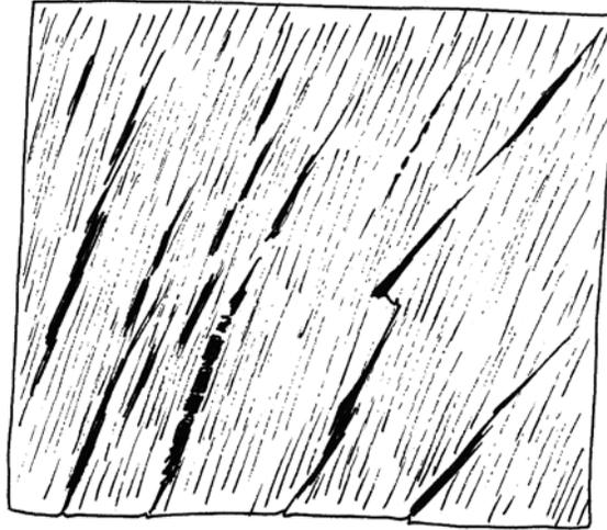
**Colapso de la madera.** Causado por el secado abrupto de la capa superficial de la madera, debido a una gradiente de secado muy alto durante el proceso, ocasionando que la madera colapse.
