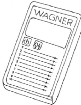
Algunos higrómetros de contacto permiten ingresar, como dato, la densidad básica de la madera, permitiendo una lectura más real. Ambos tipos de higrómetros tienen selectores. En estos selectores se especifica:
