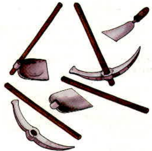
ਚਿੱਤਰ 6.6 ਲੱਕੜ ਦੇ ਹੱਥੇ (ਦਸਤੇ) ਲਗਾਉਣ ਤੋਂ ਪਹਿਲਾਂ ਸੰਦ ਗਰਮ ਕੀਤੇ ਜਾਂਦੇ ਹਨ
