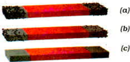
ਚਿੱਤਰ 13.6 ਚੁੰਬਕ (a) ਲੋਹੇ ਦੇ ਕਾਫੀ ਬੁਰਾਦੇ ਦੇ ਨਾਲ (b) ਕੁਝ ਬੁਰਾਦੇ ਦੇ ਨਾਲ (c) ਬਿਨਾਂ ਬੁਰਾਦੇ ਨਾਲ
