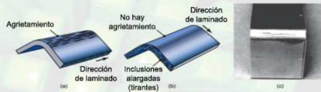
FIGURA 7.17 (a) y (b) El efecto de inclusiones alargadas (tirantes) sobre el agrietamiento en las láminas como una función de la dirección de flexión con respecto a la dirección de laminado original. Este ejemplo muestra la importancia de orientar el corte de piezas de la lámina para maximizar la plegabilidad. (c). Agrietamiento en el radio exterior de una tira de aluminio doblada en un ángulo de 90°; compare esta parte con la que se muestra en (a).
