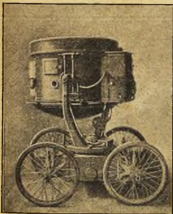
Reflector eléctrico para dar luz a los aviadores
