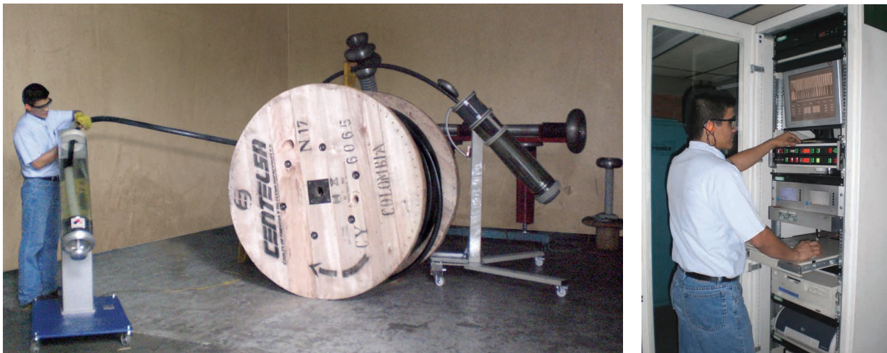
Figura 12. Laboratorio para Pruebas Descargas Parciales, Tangente Delta y Rigidez Dieléctrica
