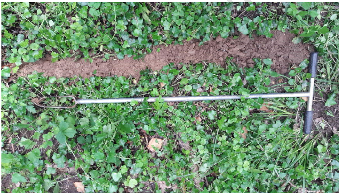
Fig. 8 – Sondage à la tarière pédologique dans une Chênaie-frênaie-ormaie alluviale du val d'Allier.
