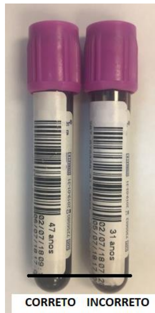
Figura 8. Etiquetas coladas na base do tubo e que geram acidentes no equipamento, pois enroscam na rack
