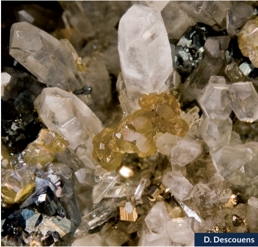
Figure 1. Quelques minéraux du Pérou. La sphalérite (ou blende) est un sulfure de zinc qui contient de petites quantités d'indium ou de germanium.
