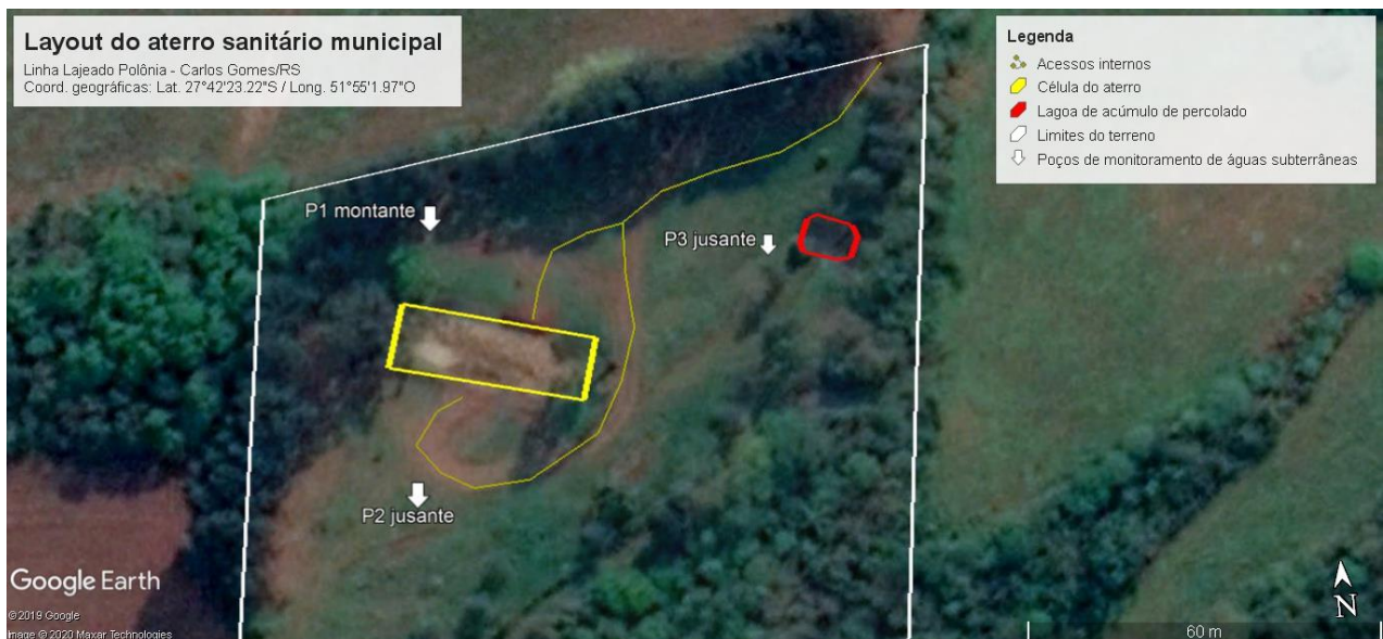
Figura 80 - Croqui evidenciando a infraestrutura física e sistemas de controle de poluição do Aterro Sanitário Municipal de Carlos Gomes/RS
