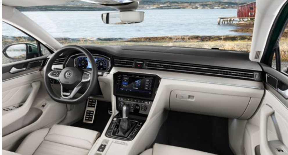
Nový multifunkčný volant s kapacitným senzorom vo venci umožnil použiť asistenčný systém Travel Assist.
