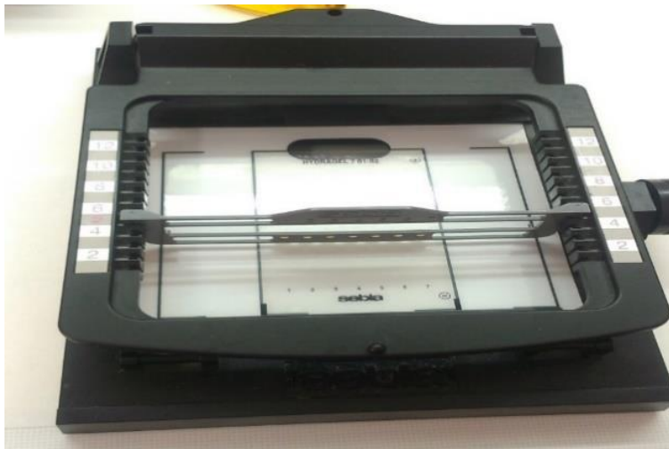
Εικόνα 11.19 Η τοποθέτηση του επιθέτη μέσα στον φορέα. Στο δάπεδο της συσκευής βρίσκεται τοποθετημένο το πήκτωμα αγαρόζης, στο οποίο διαχέονται σταδιακά τα δείγματα από τις οπές του επιθέτη. Ο φορέας αποτελείται από δύο τυπωμένα πλαίσια με αριθμημένες εγκοπές μέσα στις οποίες τοποθετούνται οι επιθέτες. Δεξιά υπάρχει ένα κομβίο ρύθμισης της θέσης, για να έρχεται σε επαφή ο επιθέτης με το πήκτωμα για την εφαρμογή των δειγμάτων.
