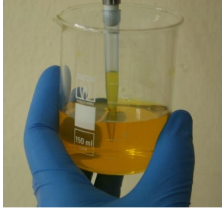
Εικόνα 1.7 Η αναρρόφηση όγκου με αυτόματη πιπέτα από ποτήρι ζέσεως. Το ρύγχος δεν πρέπει να ακουμπά στον πυθμένα του περιέκτη του υγρού ούτε όμως να είναι και κοντά στην επιφάνειά του.
