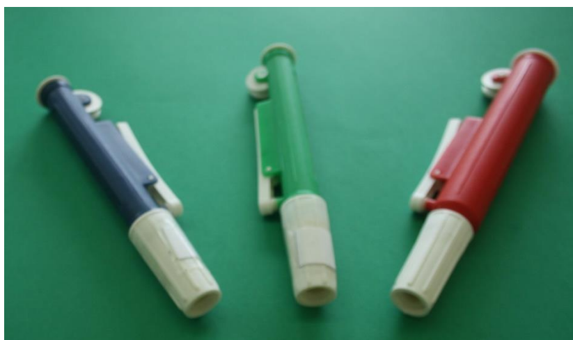
Εικόνα 1.20 Μηχανικά πουάρ (τύπος B) για τρεις διαφορετικούς όγκους σιφωνίων.
