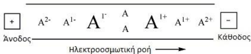
Εικόνα 11.11 Αναπαράσταση της αρχής μεθόδου της τριχλωειδικής ηλεκτροφόρησης.
