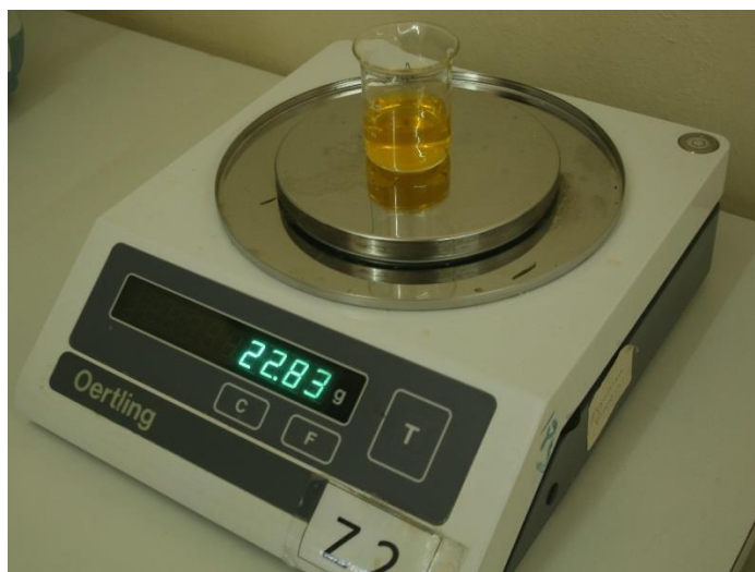
Εικόνα 1.22 Ηλεκτρονικός ζυγός δύο ψηφίων κατά τη διάρκεια της ζύγισης υγρού διαλύματος.
