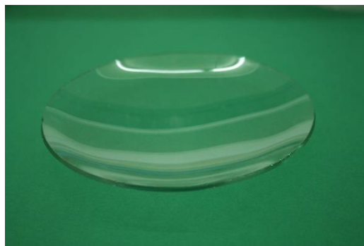
Εικόνα 1.9 Ύαλος ωρολογίου. Χρησιμοποιείται για τη ζύγιση στέρεων ουσιών πάνω σε ζυγό.
