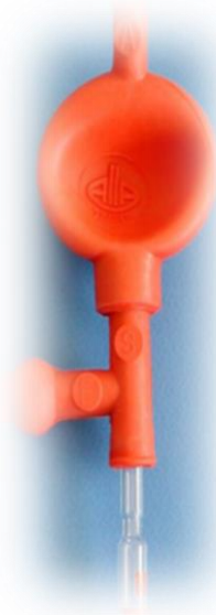
Εικόνα 1.19 Πλαστικό πουάρ (τύπος A), όπου φαίνονται τα τρία διαφορετικά πλήκτρα A, S, E.
