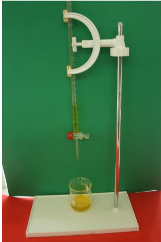
Εικόνα 1.14 Τιτλοδότηση με χρήση προχοϊδας στην οποία τοποθετείται κάποια βάση, π.χ. \text{NaOH} και στο ποτήρι ζέσεως ένα οξύ, π.χ. \text{HCl} .
