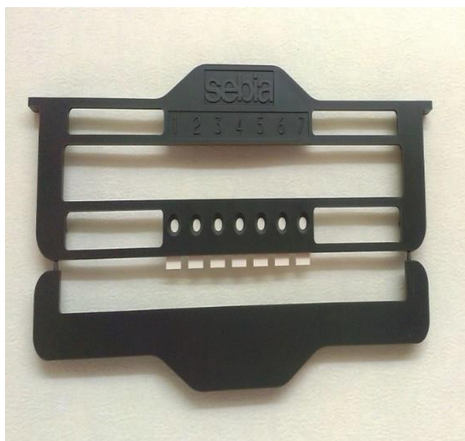
Εικόνα 11.17 Επιθέτης για τη φόρτωση των δειγμάτων στο πήκτωμα αγαρόζης. Κάτω από τις μικρές οπές που βρίσκονται στο κέντρο έχουν τοποθετηθεί μικρά διηθητικά χαρτιά. Τα διαφορετικά δείγματα τοποθετούνται στις οπές και εμποτίζουν τα διηθητικά χαρτιά, ώστε μετά την απόθεση του επιθέτη στο πήκτωμα αγαρόζης, τα δείγματα να περάσουν από τα διηθητικά χαρτιά στο πήκτωμα.
