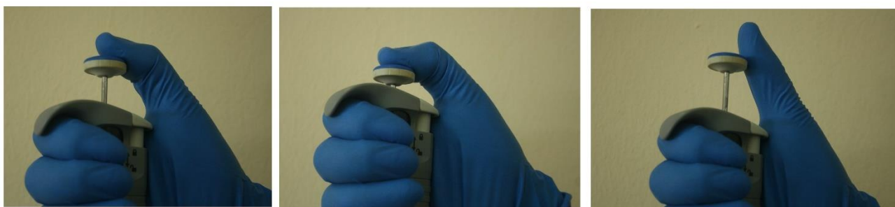
A. Φάση σταθερού κατεβάσματος του εμβόλου
