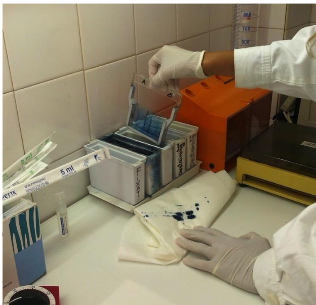
Εικόνα 11.21 Δοχεία με διαλύματα μονιμοποίησης, χρώσης και αποχρωματισμού που χρησιμοποιούνται για την κατεργασία του πηκτώματος αγαρόζης μετά την ηλεκτροφόρηση.
