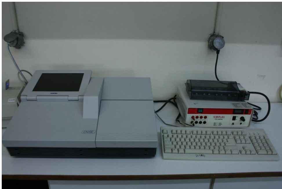
Εικόνα 11.23 Αριστερά, πυκνόμετρο για την ποσοτικοποίηση των πρωτεϊνικών κλασμάτων μετά το τέλος της ηλεκτροφόρησης και τη χρώση του πηκτώματος. Δεξιά, συσκευή ηλεκτροφόρησης (άνω) και τροφοδοτικό (κάτω) που εξασφαλίζει τη σταθερή παροχή συνεχούς ρεύματος για το διάστημα της εκτέλεσης της δοκιμασίας.
